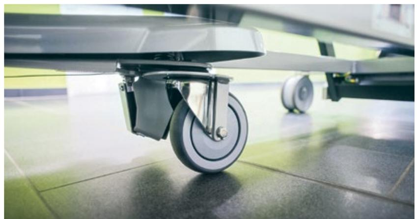
Die fünfte Rolle ist zentral zwischen den vier Hauptrollen positioniert und ermöglicht ein problemloses Manövrieren auf engen Fluren, in kleinen Zimmern und beim einfachen Drehen des Bettes auf der Stelle. In langen Gängen unterstützt sie bei der stabilen Geradeausfahrt.
