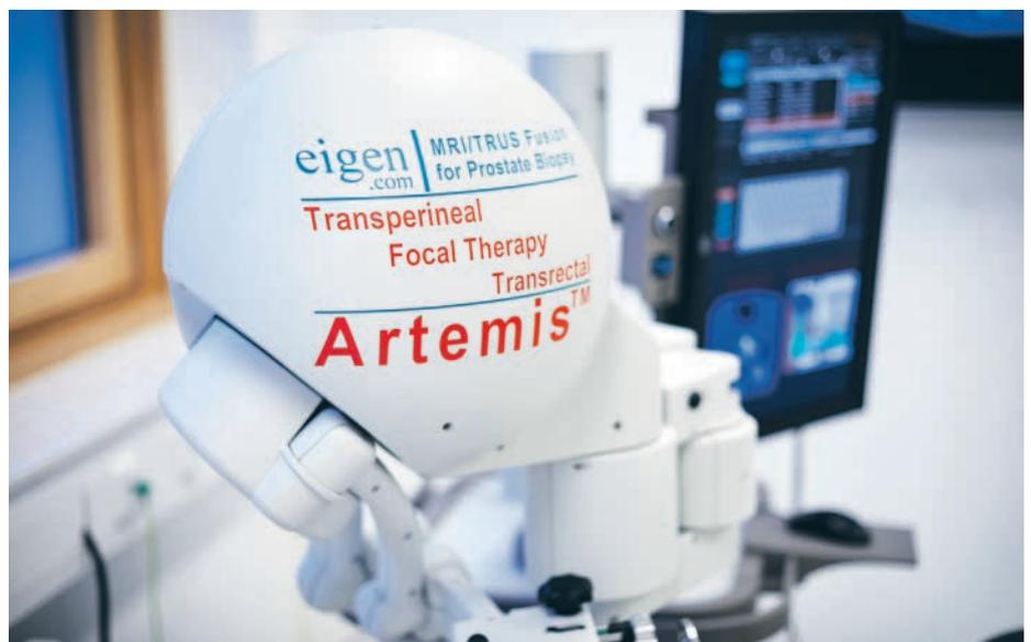
Das Artemis-System zur Entnahme von Gewebeprobe ermöglicht eine semirobotisch geführte Fusionsbiopsie in Kombination von multiparametrischem MRT und Ultraschall in Echtzeit.
