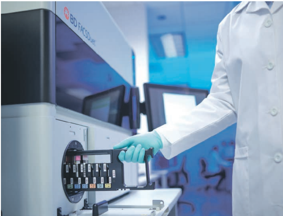
Probenbeladung BD FACSDuet: Barcodes auf dem Proben-Rack und den Primärröhrchen ermöglichen Rückverfolgbarkeit der Proben. Die Proben können kontinuierlich beladen werden.
