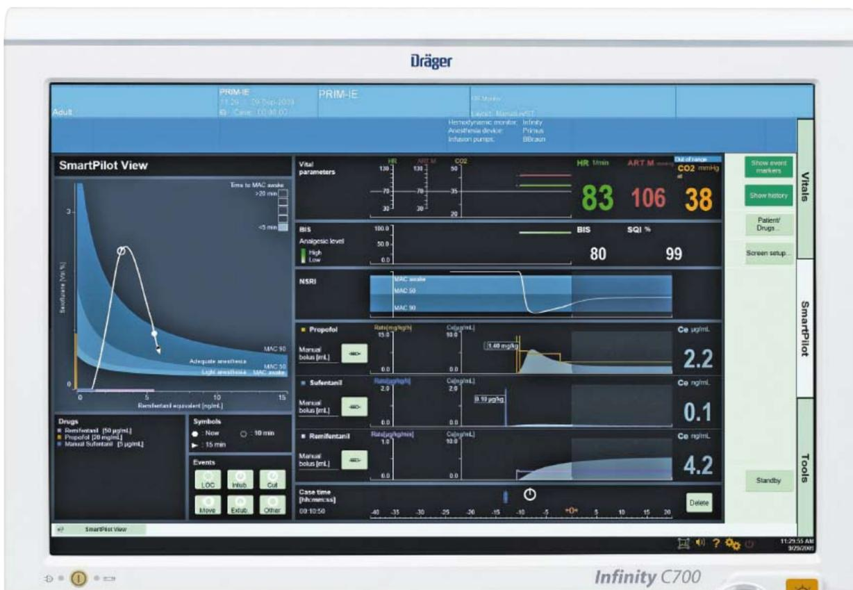
**COCKPIT IM OP** Erstmals ist mit der neuen Dräger-Software SmartPilot View eine zweidimensionale Darstellung nicht nur des errechneten aktuellen, sondern auch des prognostizierten Verlaufs des Narkoselevels in Echtzeit möglich.
