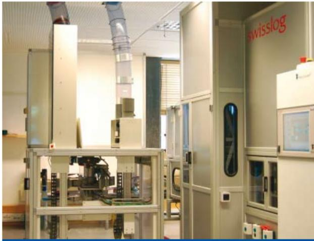
Sicherheit und Effizienz dank automatisierter Logistikprozesse. Vollautomatische Übergabe der patientengerecht kommissionierten Medikation an die Rohrpost (Pill-Pick an TranspoNet) zum barcode-gestützten Transport auf die Station
