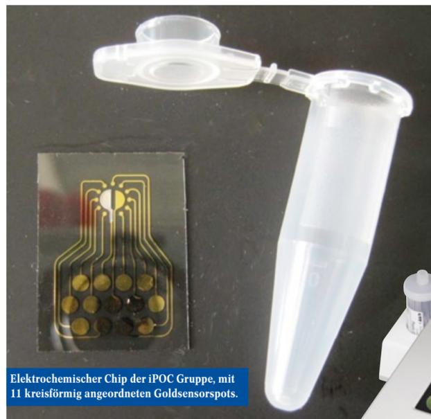
Elektrochemischer Chip der iPOC Gruppe, mit 11 kreisförmig angeordneten Goldsensortspots.
