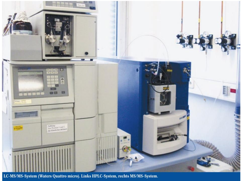
LC-MS/MS-System (Waters Quattro micro). Links HPLC-System, rechts MS/MS-System.
