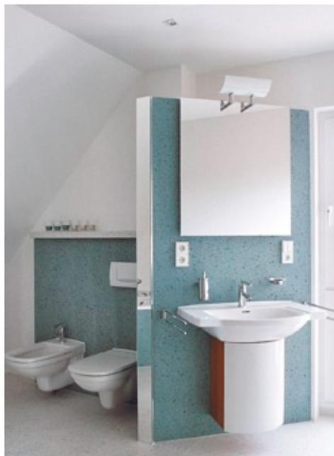
für Fertigbäder oder sind Trenn-, Vorstell- und Installationswände für vielfältige Raumsituationen. Mit ihrer gebrauchsfertigen Oberfläche sind die Wände eine Alternative zum Trockenbau. Interessante Optiken zeigen sich hier durch die Zugabe von Mineralien wie Marmor, Granit, Basalt, Quarz und Qualitäts-Farbpigmenten. Seidenmatt geschliffen, glatt entschlackt oder mit optischer Tiefe durch die Zugabe von Glasgranulat werden die Raumelemente in vielen Strukturen und Farbigkeiten produziert.
