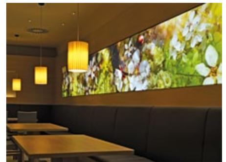
In der fensterlosen Kantine sorgt ein hinterleuchtetes Frühlingsmotiv für einen sonnigen Ausblick. Das in eine vorgesetzte Holzpanelwand flächenbündig eingebaute Leuchtssystem mit LED-Hinterleuchtung fügt sich nahtlos in das Raumbild ein.
