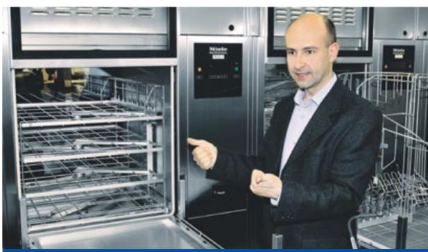
Drei neue Reinigungs- und Desinfektionsautomaten der neuesten Generation leisten jetzt dasselbe wie sieben Altgeräte – in deutlich kürzerer Zeit. Burkhard Bilitz, Technischer Leiter des Marienstifts, rechnet mit etwa 10.000 Sterilguteinheiten pro Jahr.
