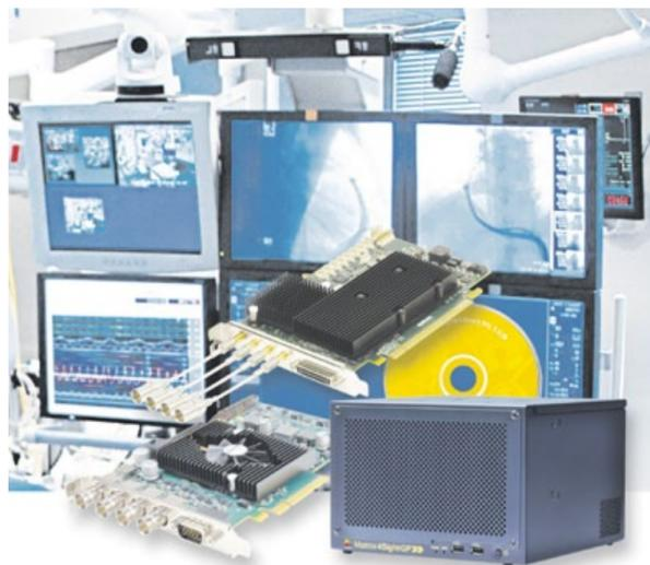
Der kleine PC bietet genau die Funktionalität, die künftige medizinische Bildgebungssysteme benötigen. Neben Gigabit Ethernet, USB 3.0, DVI und diskreten digitalen I/O-Schnittstellen bietet er PCIe-3.0-Steckplätze zur Anpassung an individuelle I/O-Bedürfnisse.
