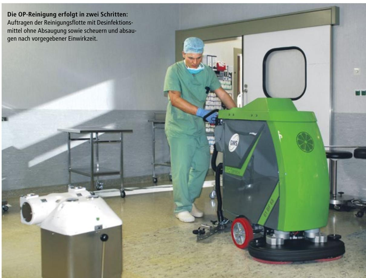
Die OP-Reinigung erfolgt in zwei Schritten: Auftragen der Reinigungsflotte mit Desinfektionsmittel ohne Absaugung sowie scheuern und absaugen nach vorgegebener Einwirkzeit.
