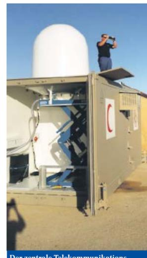
Der zentrale Telekommunikations-Shelter (kurz TC-Shelter) beherbergt die Satellitenantenne.
