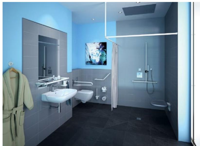
**Um Stürze im Sanitärbereich zu minimieren, sind stabile, ergonomische Griffsysteme und Handläufe unabdingbar.**
