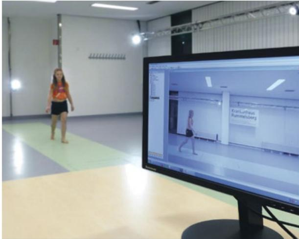
Abb. 1: Einfach, schnell, realistisch: Im bildbasierten System reichen wenige Marker aus, um eine aussagefähige Ganganalyse zu erstellen.
