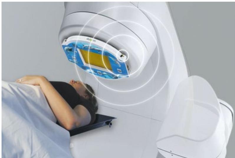
Abb. 2: Transmissionsdosimetrie-System. Der Transmissionsdetektor wird direkt an das Strahlenausgangsfenster des Linearbeschleunigers angebracht. Somit kann während der Patientenbestrahlung die Strahlapplikation gemessen werden. Die Datenübertragung erfolgt kabellos.
