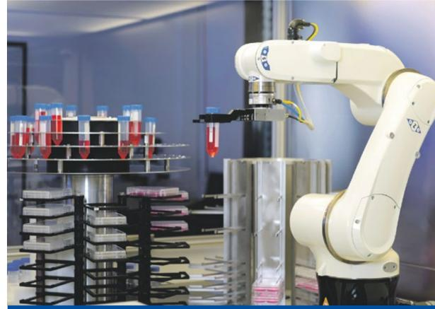
Im Projekt „AUTOSTEM“ unterstützt ein Roboterarm die Prozessführung zur automatisierten Produktion von mesenchymalen Stammzellen. Foto: Fraunhofer IPT
