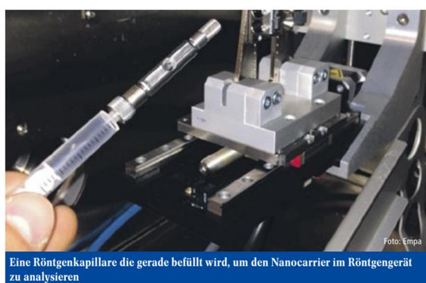
Eine Röntgenkapillare die gerade befüllt wird, um den Nanocarrier im Röntgengerät zu analysieren
