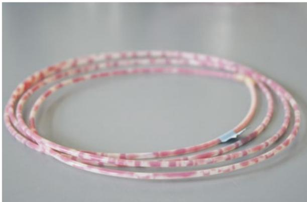
Prüfkörper zur Kontrolle der Gesamtprozessleistung von RDG-E-Prozessen, bestehend aus einem Schlauchelement mit einer Testanschmutzung aus reaktiviertem Schafblut und  $>10^9$  Enterococcus faecium, als Prüforganismen entsprechend Anlage 9 der Leitlinie von DGKH, DEGEA, DGSV, DGVS und AKI
