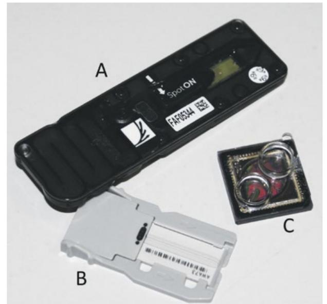
Abb. 1: Sequenzierkamern der drei derzeit gängigsten Vollgenomsequenzier-Plattformen. A) MinION-SpotON Flowcell, B) Illumina MiSeq FlowCell, C) Ion 318 Chip. Foto: M. Antwerpen, IMB
