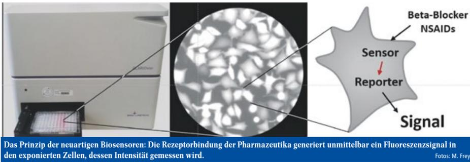
Das Prinzip der neuartigen Biosensoren: Die Rezeptorbindung der Pharmazeutika generiert unmittelbar ein Fluoreszenzsignal in den exponierten Zellen, dessen Intensität gemessen wird. Fotos: M. Frey
