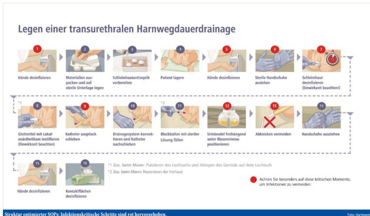
Struktur optimierter SOPs: Infektionskritische Schritte sind rot hervorgehoben.
