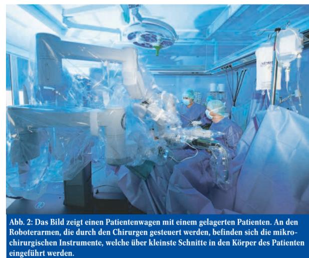
Abb. 2: Das Bild zeigt einen Patientenwagen mit einem gelagerten Patienten. An den Roboterarmen, die durch den Chirurgen gesteuert werden, befinden sich die mikrochirurgischen Instrumente, welche über kleinste Schnitte in den Körper des Patienten eingeführt werden.
