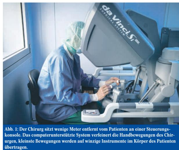
Abb. 1: Der Chirurg sitzt wenige Meter entfernt vom Patienten an einer Steuerungskonsole. Das computerunterstützte System verfeinert die Handbewegungen des Chirurgen, kleinste Bewegungen werden auf winzige Instrumente im Körper des Patienten übertragen.
