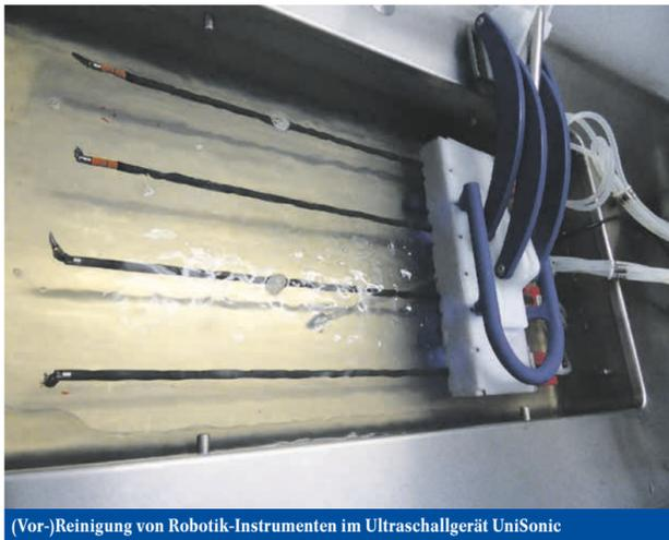
(Vor-)Reinigung von Robotik-Instrumenten im Ultraschallgerät UniSonic
