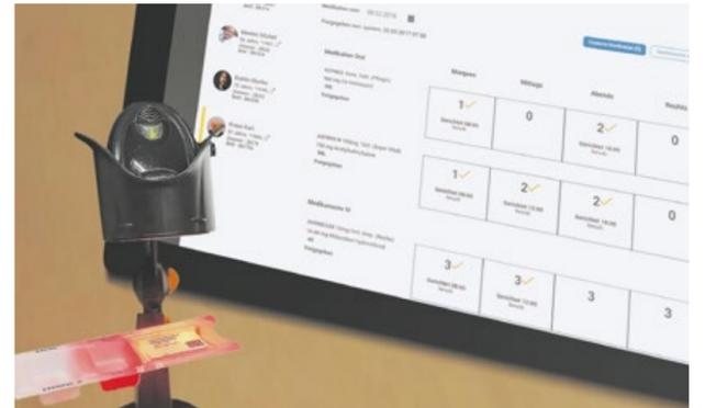
Falsche Medikamentenstellung ausschließen. Ein ausgeklügeltes System, bestehend aus dem Scannen der Barcodes auf dem Dispenser und der Medikamentenverpackung sowie der Bestätigung per Fingertipp auf dem Touchscreen, macht eine Fehlstellung praktisch unmöglich.
