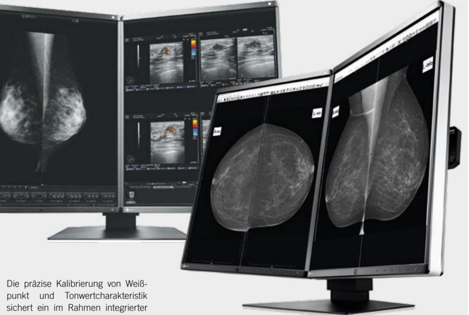
Die präzise Kalibrierung von Weißpunkt und Tonwertcharakteristik sichert ein im Rahmen integrierter Frontsensor (IFS). Dieser misst Helligkeit und Graustufen und kalibriert den Monitor selbstständig nach dem DICOM-Standard. Der Sensor arbeitet automatisch, ohne dabei das Sichtfeld des Monitors einzuschränken. Das spart Wartungsaufwand und Wartezeiten ein und garantiert eine stets gleichbleibende Bildqualität.
