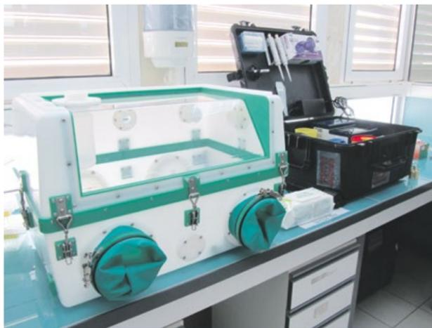
Komplettes Kofferlabor (r.) mit Handschuhbox (l.). Der Betrieb erfolgt über eine Solarbatterie. Foto: Ahmed Abd El Wahed
