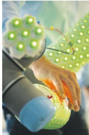
Ein Beispiel für die künstliche Roboterhaut auf einem Industrieroboterarm, wenn man sie berührt, weicht der Roboterarm aus.
