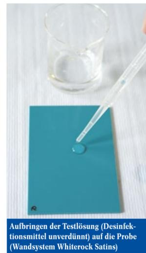
Aufbringen der Testlösung (Desinfektionsmittel unverdünnt) auf die Probe (Wandsystem Whiterock Satins)
