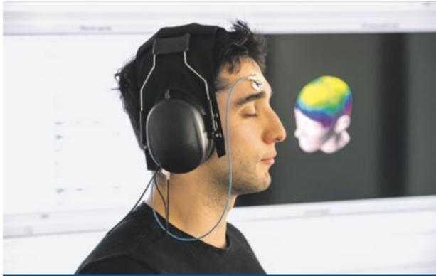
Ein Beispiel für eine Gehirn-Maschine-Schnittstelle: die Hirnaktivität wird aufgezeichnet während der Computer einen einfachen Gedanken in einen Befehl für ein Gerät übersetzt.
