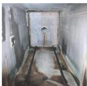
Systematisch: Korrosion im Sterilisator
