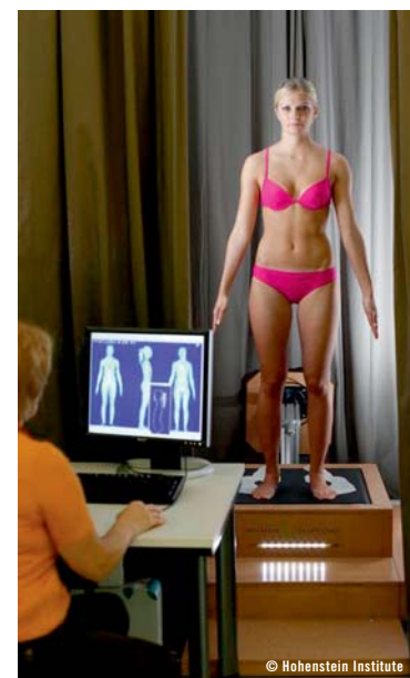
Abb. 1: Mit Hilfe modernster 3D-Bodyscanner wurden die anatomischen Werte von Brustkrebs-Patientinnen berührungsfrei ermittelt und daraus eine die ideale Schnittführung des Spezial-BHs abgeleitet.
