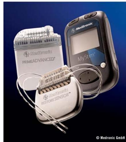
Abb. 2: Wiederaufladbarer (klein) und nicht wiederaufladbarer Neurostimulator mit Elektroden und Patienten-Handsteuergerät myStim.
