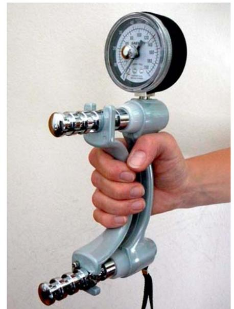
Abb. 1: Griffstärkemessgerät.
