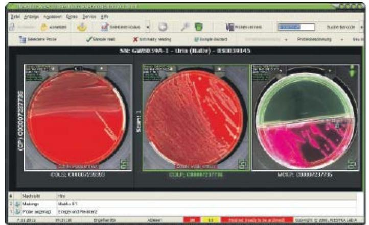
**Abb. 2:** Urinkulturplatten im ReadA-Browser von Kiestra. Agarplatten werden automatisch nach festgelegten Inkubationszeiten fotografiert und archiviert.
