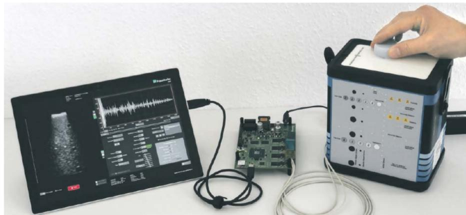
Evaluierung der noch unverbauten „VislMon“-Elektronik an einem Standard-Ultraschallphantom. Bei dem Größenvergleich mit dem Tablet zeigt sich der hohe Kompaktheitsgrad der Elektronik (Bildmitte). Der Ultraschallwandler (in der Hand des Anwenders auf dem Phantom) hat ebenfalls nur einen Durchmesser von 40 mm.
