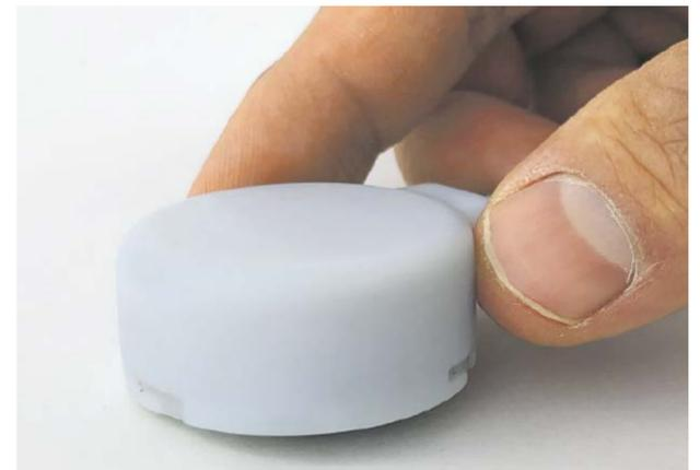
Nahaufnahme des 32-elementigen selbstklebenden Ultraschallwandlers zur Bildgebung der Blase
