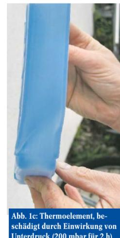
Abb. 1c: Thermoelement, beschädigt durch Einwirkung von Unterdruck (200 mbar für 2 h)
