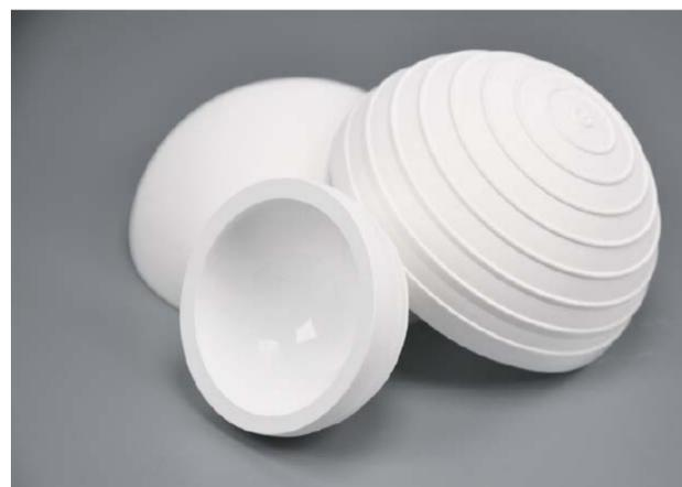
Die gegossenen Halbschalen für die Oberflächenersatzprothese sind auf einer Seite aufgeraut, damit die Knochenzellen besser anwachsen. Foto: Fraunhofer IKTS
