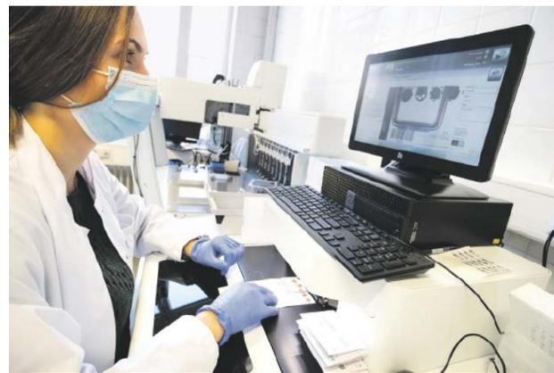
Robotisch assistiertes Ausstanzen von Trockenblutproben (DBS)
