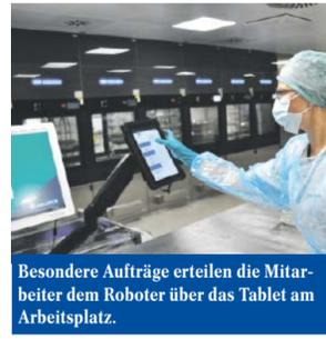
Besondere Aufträge erteilen die Mitarbeiter dem Roboter über das Tablet am Arbeitsplatz.
