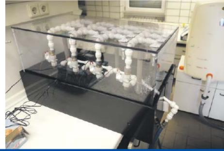
Versuchsaufbau der Strahlregleruntersuchungen: (a) Prüfstand geöffnet, (b) Prüfstand geschlossen und (c) Einzelprüfung
