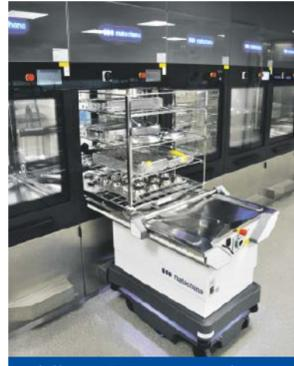
Mithilfe von RFID-Antennen erkennt die Reinigungsmaschine den nahenden Roboter und öffnet die Tür. Der AL10 schiebt den Beladungsträger in die Maschine, die daraufhin das passende Reinigungsprogramm startet.
