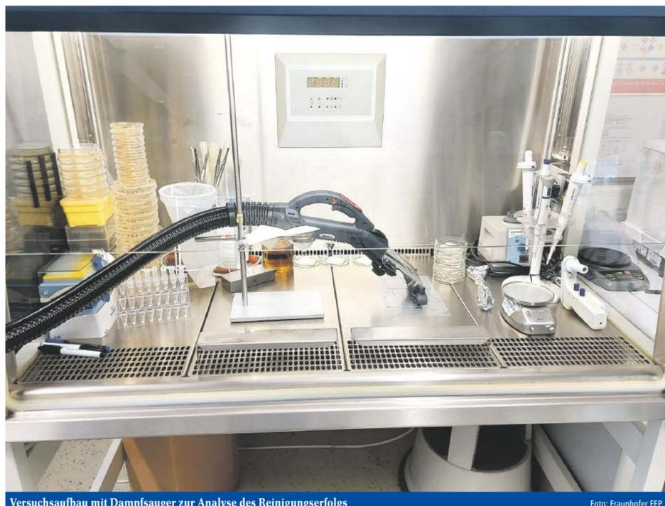
Versuchsaufbau mit Dampfsauger zur Analyse des Reinigungserfolgs
