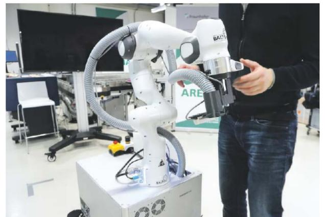
Am Technologiepark NOI in Bozen ist ein Demonstrator des Desinfektionsroboters im Einsatz. Fotos: Fraunhofer Italia
