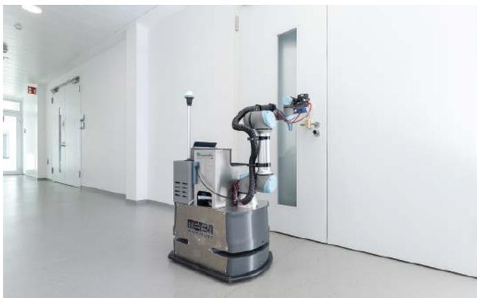
Die Arbeiten des Fraunhofer IPA zur Reinigung und Desinfektion von Oberflächen basieren auf dem Roboter „DeKonBot 2“ und entwickeln dessen Fähigkeiten weiter.
