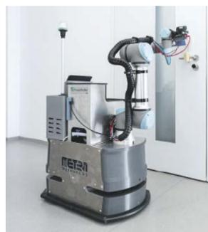
Die Arbeiten des Fraunhofer IPA zur Reinigung und Desinfektion von Oberflächen basieren auf dem Roboter „DeKonBot 2“. Foto: Fraunhofer IPA/Foto: Rainer Bez.
