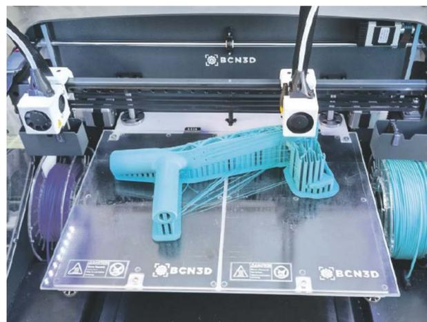
Abb. 1: 3D-Druck Gehstützenoberteil
