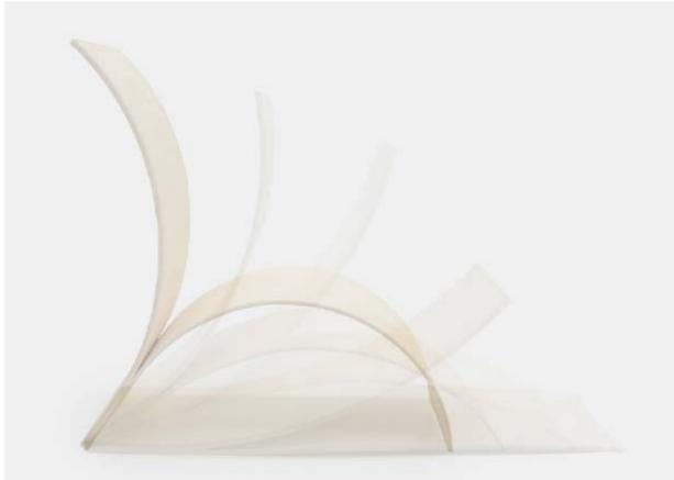
Etappen des Selbstformungsprozesses: Durch Lufttrocknen formt sich die flache, kompakte Konfiguration in die stabile, gekrümmte Geometrie eines Stuhls. Foto: Robert Faulkner, Universität Stuttgart / ICD
