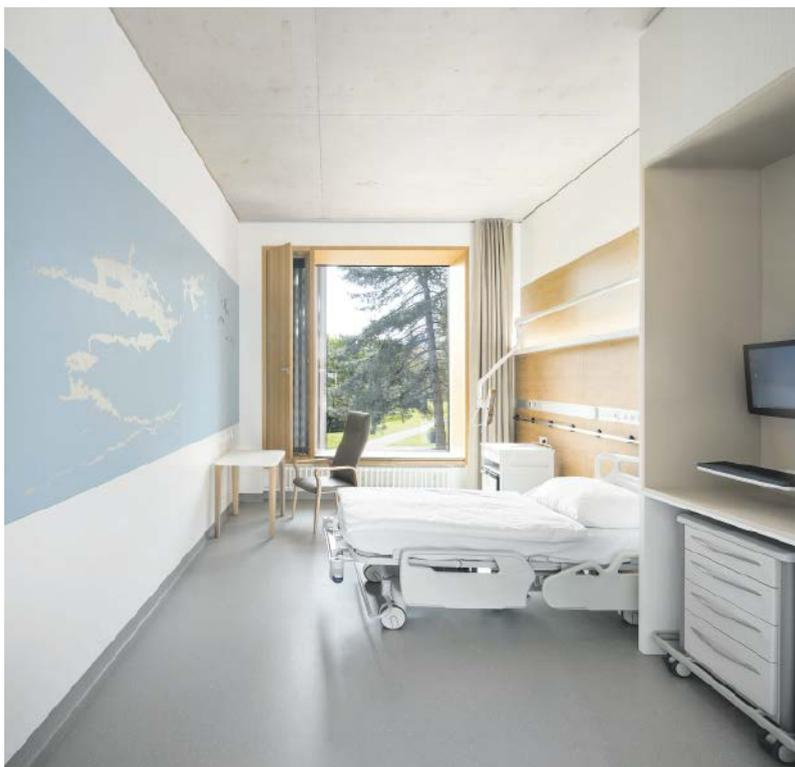
Bei den beschichtungsfreien Nora Kautschukböden entfällt die jährliche Beschichtungserneuerung – dies spart Zeit und Geld.
