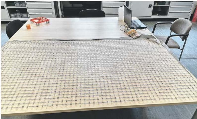
Der Grundmattenkörper besteht aus Silikon. Darin integriert sind eine Druckmessmatrix und Auswerteelektronik.
