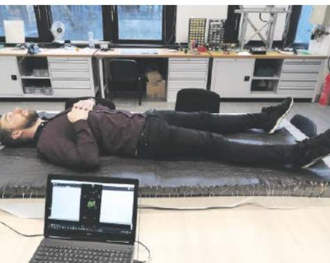
Tests mit dem Prototyp der im Projekt entwickelten Anti-Dekubitus-Matte haben gezeigt, dass diese Druckstellen auf der Liegefläche messen und dadurch mögliche Dekubitus-Gefahrenbereiche ermitteln kann.
