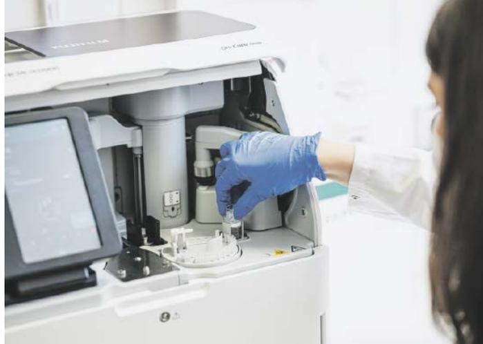
Der Fuji Dri-Chem-Analyser FDC NX600 erhebt sämtliche Notfallparameter aus dem Bereich der Klinischen Chemie.
