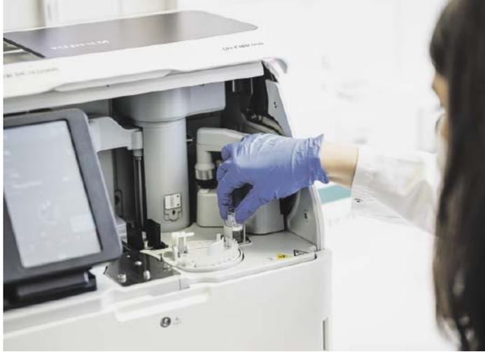
**Der Fuji Dri-Chem-Analyser FDC NX600 erhebt sämtliche Notfallparameter aus dem Bereich der Klinischen Chemie.**
