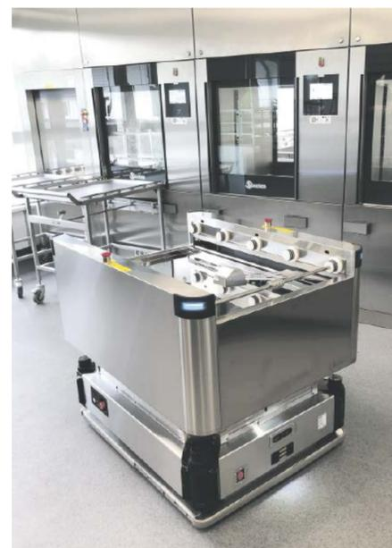
Herzstück des automatischen Transfersystems von Steelco: ein Transportroboter, der die Geräte selbstständig be- und entlädt. Foto: Steelco
