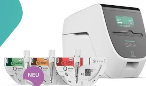
Rhonda ist ein einfach zu bedienendes PCR-Schnelltestsystem für den zuverlässigen Nachweis von bakteriellen und viralen Erregern am Point of Care. Analysen laufen in deutlich unter einer Stunde vollautomatisiert und bei minimaler hands-on time: die Abstrichprobe des Patienten kann direkt in die Rhonda disk überführt werden, Pipettieren entfällt!
