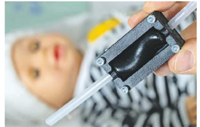
3D-Modell einer Mikropumpe, wie sie im Projekt entwickelt werden soll
