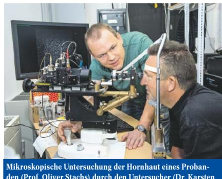
Mikroskopische Untersuchung der Hornhaut eines Probanden (Prof. Oliver Stachs) durch den Untersucher (Dr. Karsten Sperlich) am Laboraufbau eines prototypischen Laserscanning-Mikroskops
