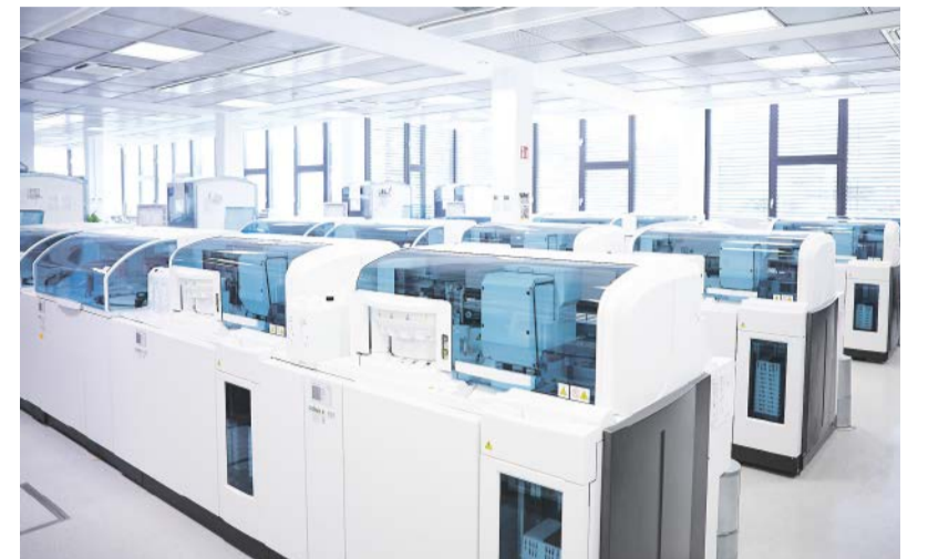
Abb. 3: COBAS-Analysengeräte (Roche) können sowohl als Einzel- bzw. Insellösung, als auch in eine TLA integriert werden. Foto: MVZ Labor 28
