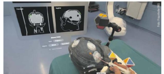
Das am Fraunhofer IWU in Zittau entwickelte und 3D-gedruckte Handstück für Operationsinstrumente enthält Marker-Geometrien, die von der Datenbrille erkannt werden.
