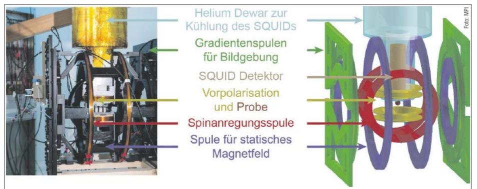
Bild und Schematik des Ultrahochfeld Prototyps am Max-Planck-Institut für biologische Kybernetik in Tübingen
