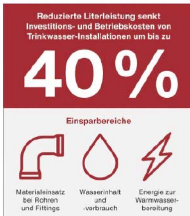
Bei der Planung von Neubauten bietet sich das höchste ökonomische und ökologische Potential durch reduzierte Durchflussmengen und die bevorzugte Verwendung von T-Stück-Installationen. Materialeinsatz, Wasser- und Energieverbrauch können auf diese Weise um bis zu 40% reduziert werden. Zugleich begünstigt ein verringerter Wasserinhalt den Wasserwechsel und somit einen hygienischen Betrieb.
