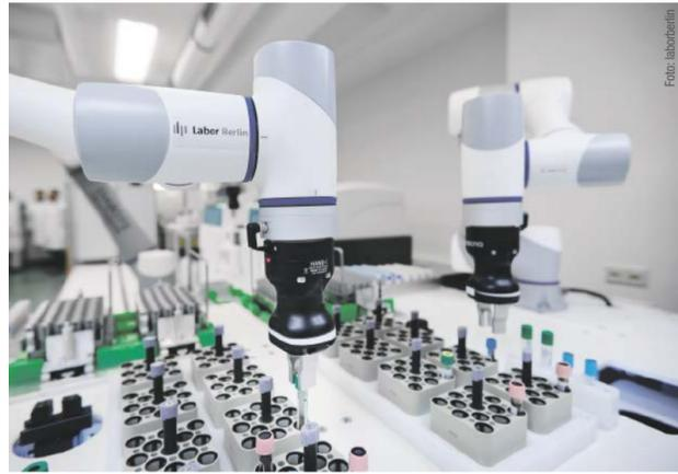
In der Präanalytik-Einheit stellen Roboter „Heini“ (l.) und „Heino“ (r.) registrierte Proben in die Zentrifugenmodule.
