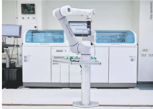
Roboter „Friedrich“ ist auf einer Schiene mobil und transportiert ein Probenrack von der präanalytischen Einheit zum Analyzer für die klinische Chemie.
